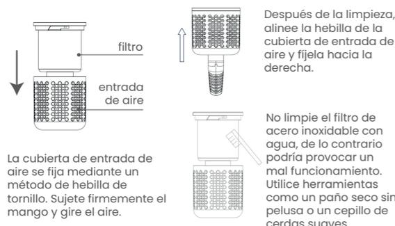
La cubierta de entrada de aire se fija mediante un método de hebilla de tornillo. Sujete firmemente el mango y gire el aire.
