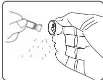
1. Use un cepillo de limpieza para barrer el vello recortado del cabezal de corte y ranuras del cuerpo del aparato.
