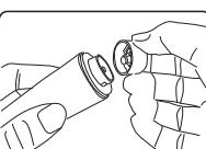
2. Alinee el eje de rotación del cabezal de corte e inserte lentamente la ranura de la pared interior del cabezal de corte en la ranura del aparato.
