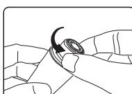
1. Gire el cabezal de corte en sentido antihorario para extraer fácilmente el cabezal de corte.
