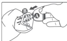
1. Coloque la cuchilla (parte A) en el cuerpo de la recortadora (ranuras B)
